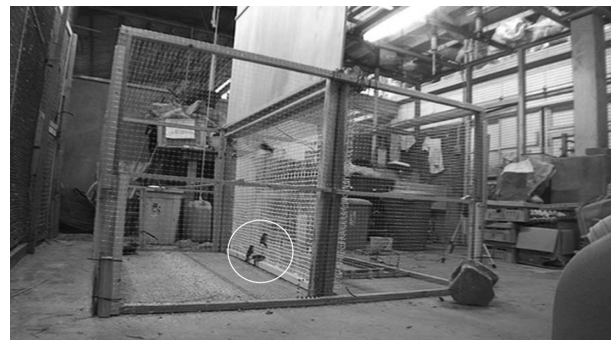
第3図 目合い2.0cmのネットをスズメが通り抜けできない状況
