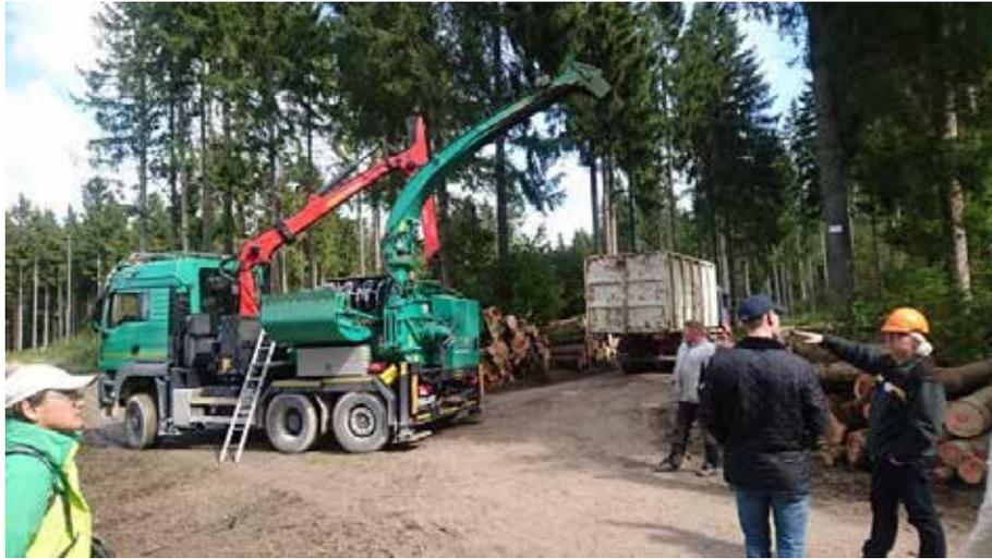
写真 ウッドチップ生産現場（移動式チップパー）
