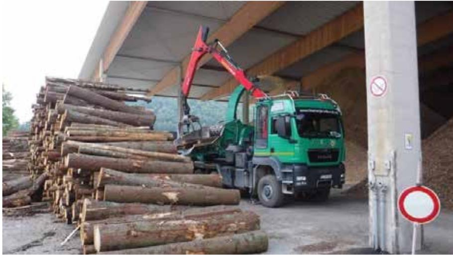
写真 ウッドチップ工場（移動式チップパー）
